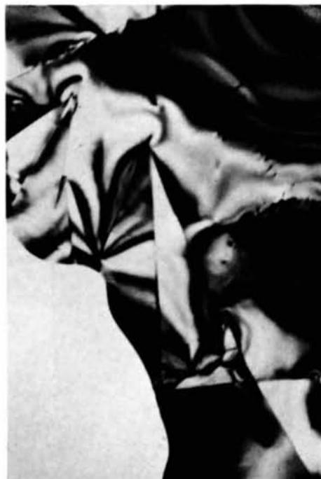
Fig. 10. Cristal hexagonal de  $A\text{-Nd}_2\text{O}_3$  montrant au centre de la photographie une région monoclinique  $B\text{-Nd}_2\text{O}_3$ , de forme triangulaire, comportant une macle ( $\times 45600$ ).
