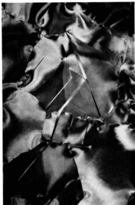
Fig. 5. Bandes de  $B\text{-Nd}_2\text{O}_3$  dans  $A\text{-Nd}_2\text{O}_3$  ( $\times 20000$ ).
