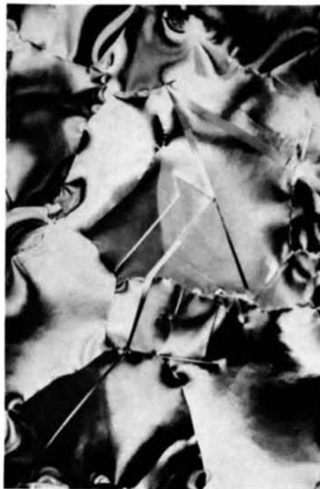
Fig. 6. Bandes de  $B\text{-Nd}_2\text{O}_3$  dans  $A\text{-Nd}_2\text{O}_3$ , 15 secondes après la prise de la Fig. 5 ( $\times 20000$ ).
