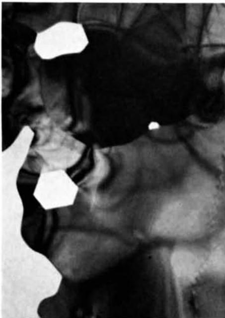
Fig. 3. Trous à formes géométriques régulières (angles de  $120^\circ\text{C}$ ) dans un cristal  $A\text{-Nd}_2\text{O}_3$  ( $\times 40000$ ).
