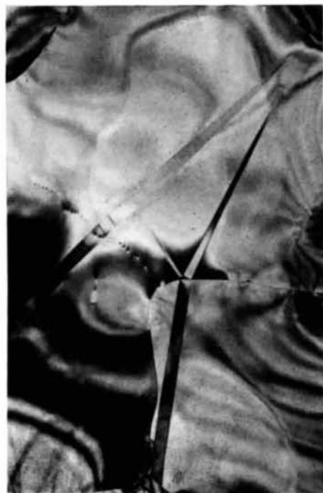
Fig. 7. Bandes de  $B\text{-Nd}_2\text{O}_3$  dans  $A\text{-Nd}_2\text{O}_3$  ( $\times 45600$ ).
