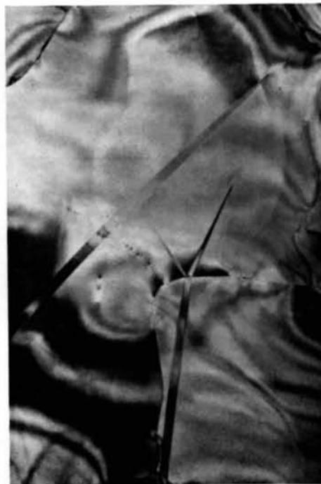
Fig. 8. Bandes de  $B\text{-Nd}_2\text{O}_3$  dans  $A\text{-Nd}_2\text{O}_3$ , 15 secondes après la prise de la Fig. 7 ( $\times 45600$ ).
